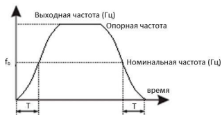
Рис. 6-3 Кривая S разгона/торможения В
