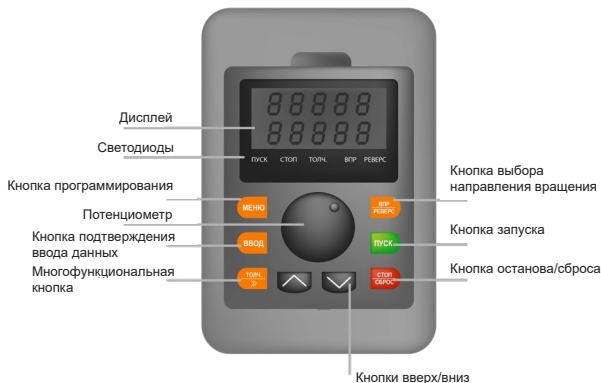
Рис. 5.1 – Функции кнопок и светодиодов панели управления LCI
